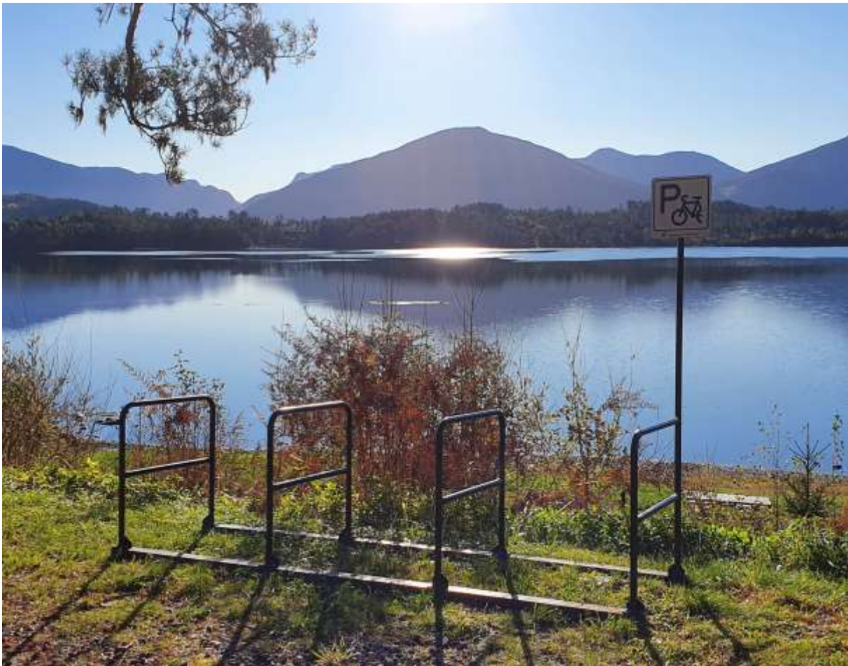
Sykkelparkeringsstativ frå Simek i Stordal på plass i Murvika i Skodje. A-forma gjer det råd å låse fast både ramme og hjul på syklane, og gir god støtte.
