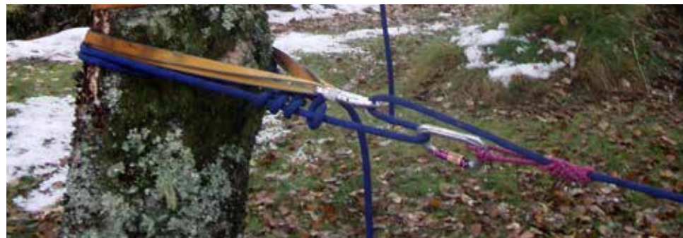
Bilde 1: Taubru med slynger, talje og friksjonsavbinding i rett linje/same plan!
