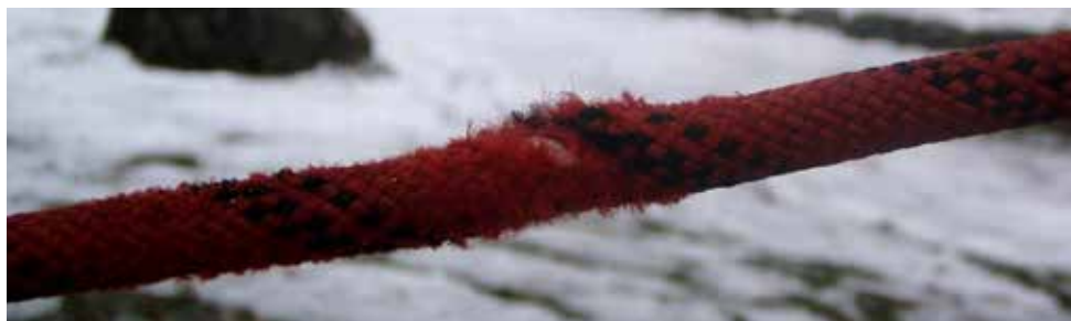
Bilde 39: Eksempel på skadd strømpe på taubrutau.
