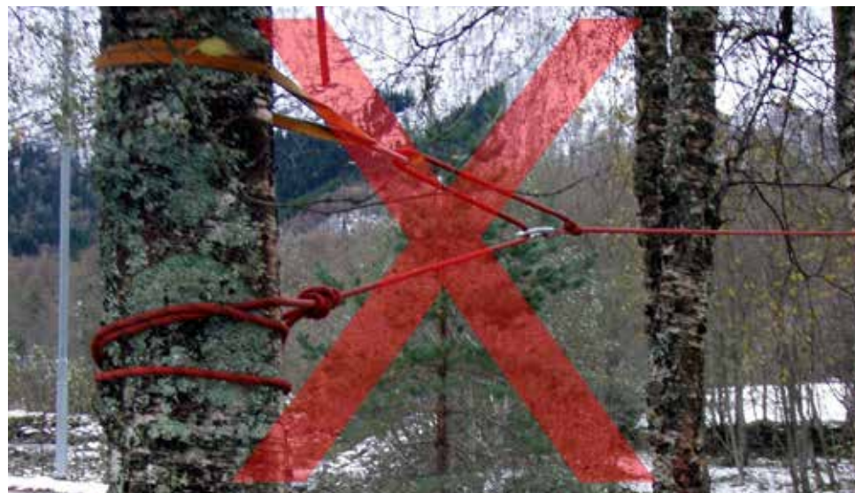
Bilde 2: Taubru med feil oppsett der friksjonsavbindinga vil fungere svært dårleg fordi den ikkje er på linje med slynge og tau!
